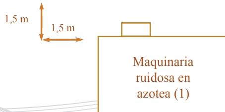
Figura 3: Situación del punto de medida para la evaluación de maquinaria ruidosa en cubierta
